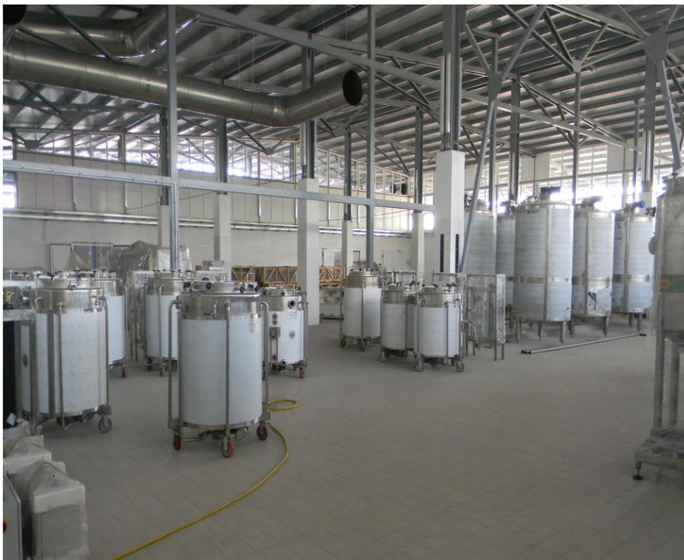
Беструбопроводная технология позволяет исключить потери сырья и продукта в трубопроводах и насосах так как исключаются из процесса сами линии подачи и возврата продукта на фасовку, и линии подачи и возврата моющих средств, что благоприятно сказывается на качестве готового продукта и сокращают его потери по объему (до 30% емкости трубопроводов, плюс остатки продукта в насосах в размере 1,5-2,5 литра на один насос).
