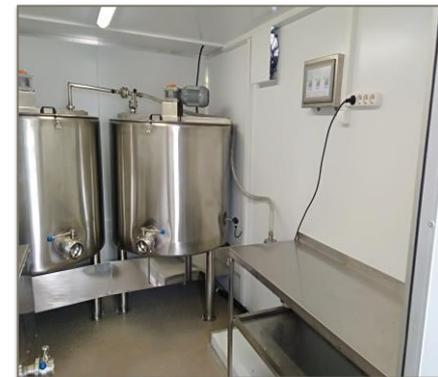
Емкости с мешалками (до 20 об/мин) и «рубашками» нагрева (до +92 °С) и охлаждения (до +4 °С).
