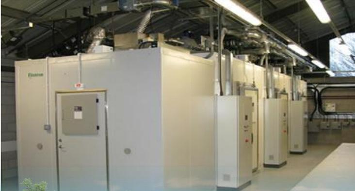
Камеры оснащены системами автоматического поддержания заданной температуры от 2 до 40 градусов и системой автоматического поддержания заданной влажности от 35% до 95%
